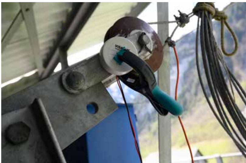
Kontaktmikrofone kommen an Kabinen, Masten und Seile.
