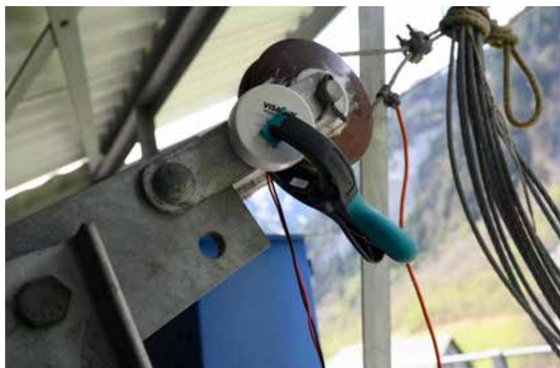
Pose de microphones de contact sur les cabines, pylônes et câbles.
